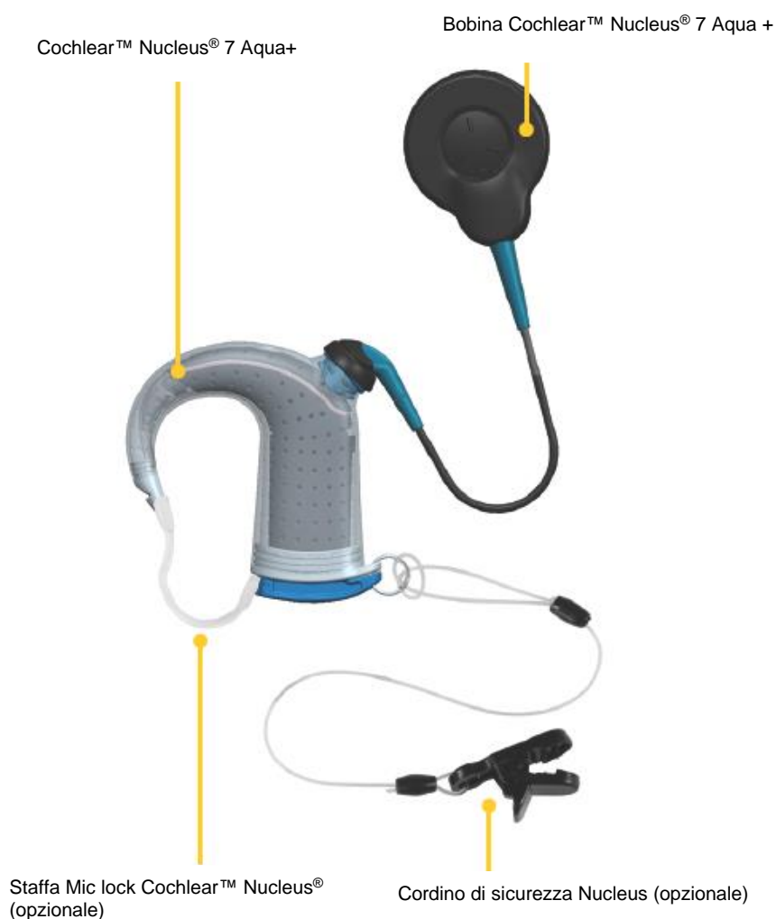
Figura 1: dispositivo Cochlear™ Nucleus® 7 Acqua+ (per processore Nucleus 7 con batteria ricaricabile standard)
