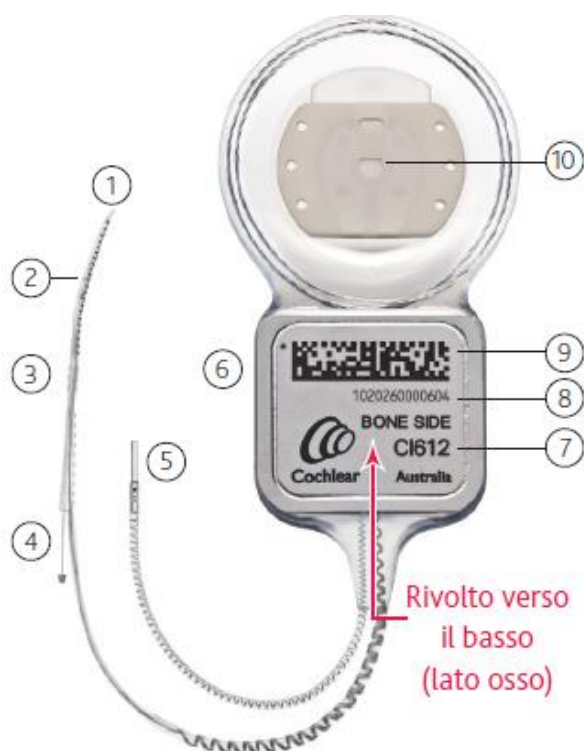
Figura 1: impianto cocleare CI612 con elettrodo Contour Advance® (lato osso)
